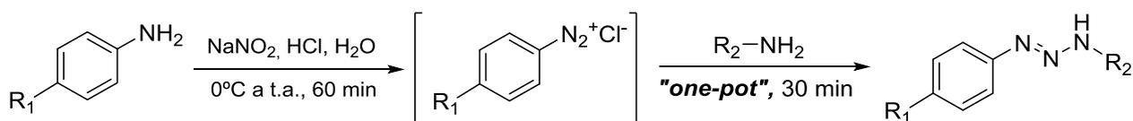
**Esquema 1.** Rota de síntese de triazenos à partir da diazotação de aminas aromáticas ( $\text{R}_1 = \text{CO}_2$ ,  $\text{NO}_2$  e  $\text{R}_2 = \text{aril}$ ).
