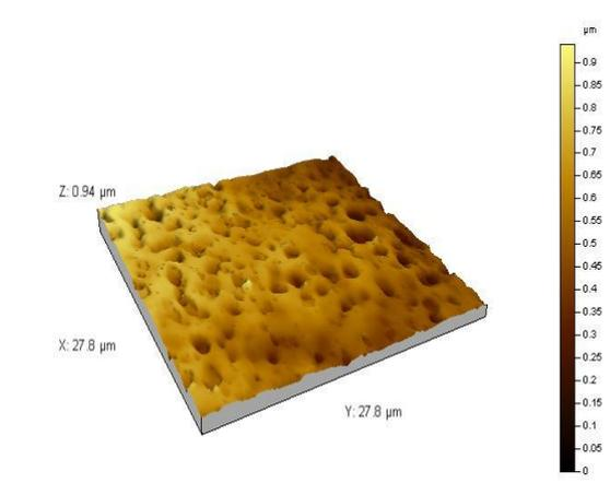
**Figura 4:** Imagem em 3-D de AFM onde são verificadas a formação de algumas cavidades moldadas com PE de 1,1 μm em filme de Pt.
