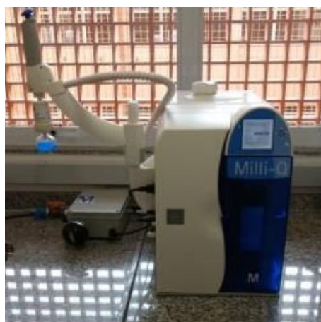
Figura 1: Sistema Milli-Q Direct 8 instalado na CEM-SBC
