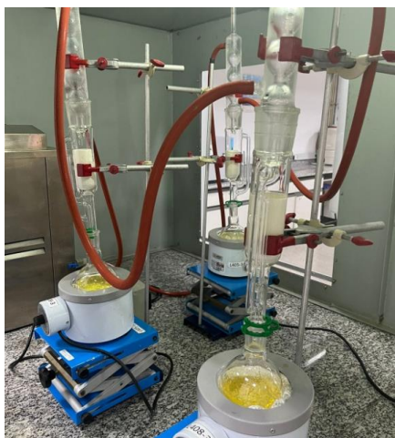
Figura 4: Processo de extração de óleo de soja em laboratório
