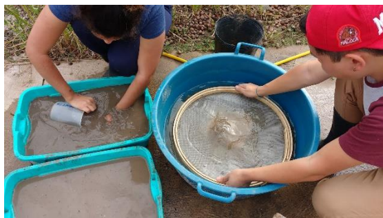
Figura 5: Material sendo filtrado pela segunda vez por uma peneira de malha menor do que a utilizada na primeira triagem.
