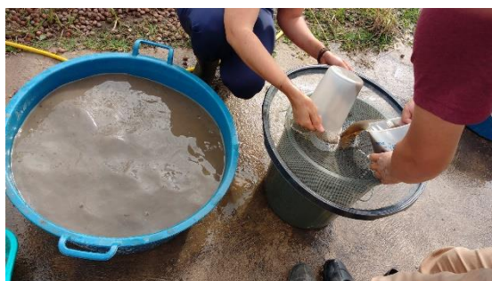
Figura 8: Material sendo peneirado pela terceira vez.
