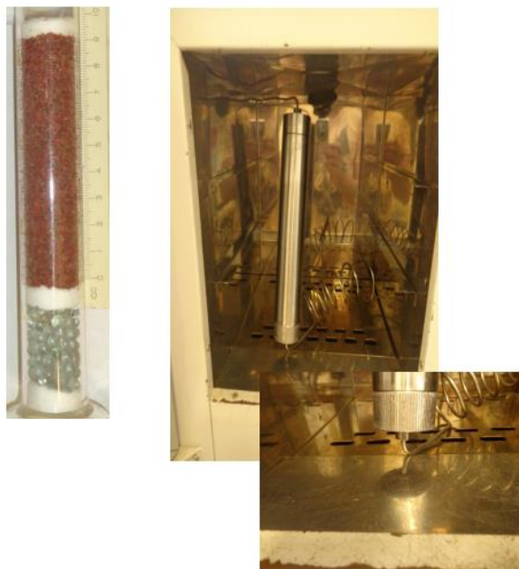
Figura 3A – Coluna de extração compactada com a amostra e pérolas de vidro (45 mL).
