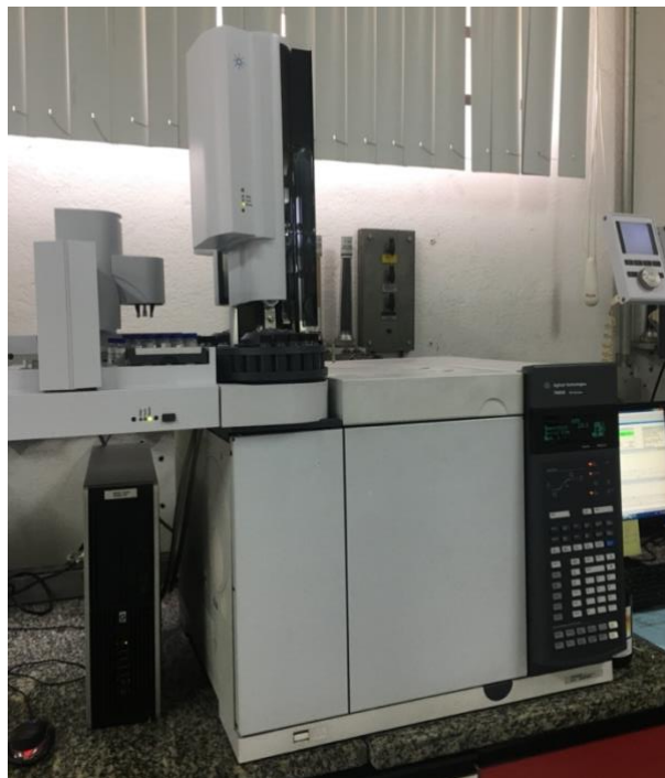
Figura 4 Cromatógrafo a gás com detector de ionização de chama e injetor automático utilizado neste estudo
