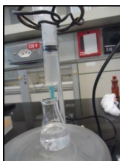
Figura 5: Esquema utilizado para formação das cápsulas de CaAlg, contendo proteína.
