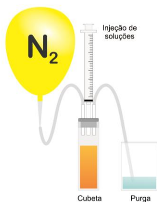
Figura 3 – Esquema da montagem do aparato para leituras espectrofotométricas para acompanhamento cinético das reações de transferência eletrônica
