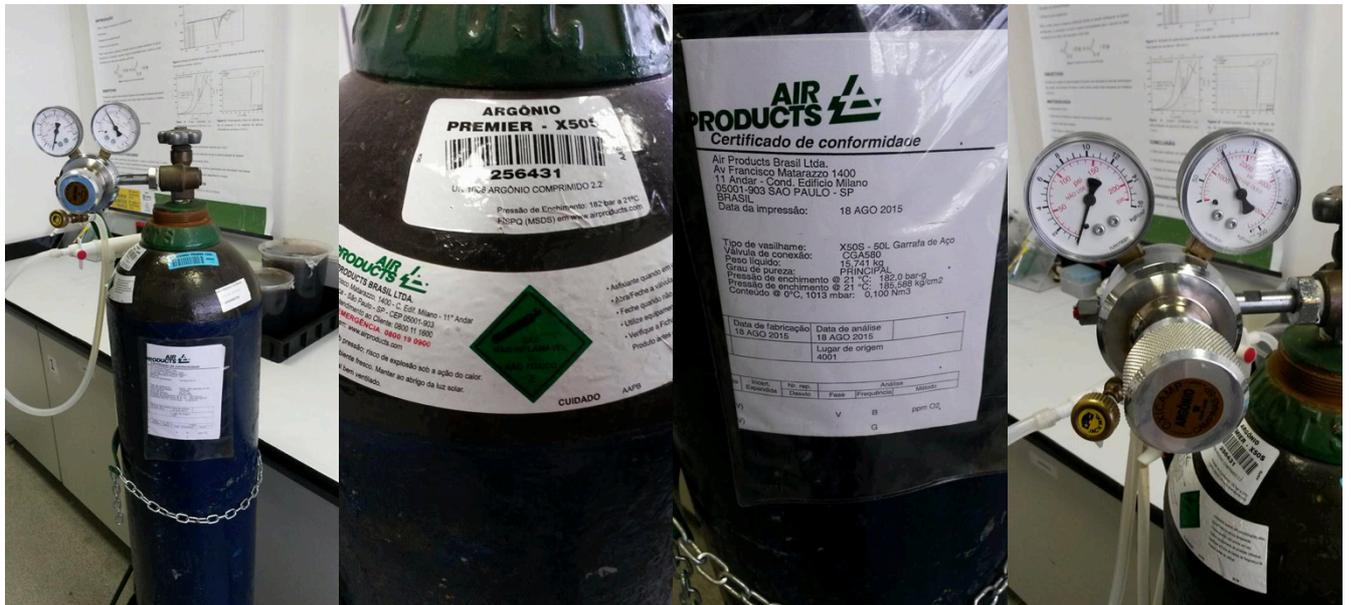
**Figura 4.** Cilindro de gás e válvula reguladora de pressão instalados no laboratório de pesquisa L204 (Bloco B, Campus SA, UFABC).
