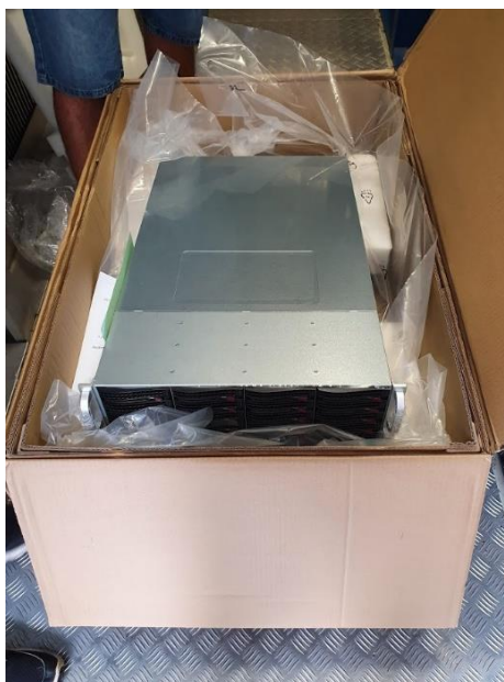
FIGURA 1: GAVETA DE DISCOS (JBOD) ADQUIRIDA COM VERBAS DA RTI ENCONTRA-SE EM FUNCIONAMENTO.
