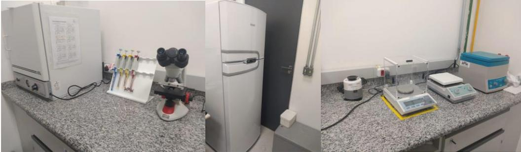
Figura 3. Da esquerda para a direita: estufa de secagem e esterilização, conjunto de micropipetas, microscópio ótico, refrigerador, agitador Vortex, balança de precisão, agitador magnético com aquecedor e centrífuga adquiridos com recursos da RTI e instalados no Laboratório de Controle Sanitário.
